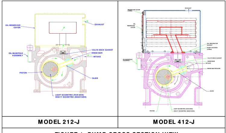
FIGURE 1 PUMP CROSS SECTION VIEW
